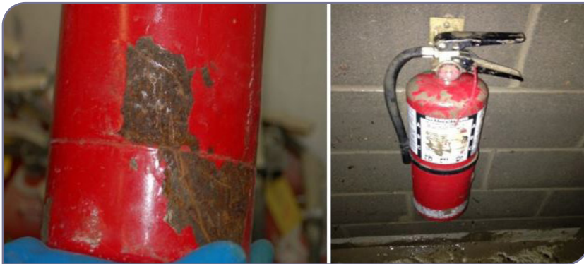
شکل ۴-۶. از بین رفتن رنگ خاموش کننده
