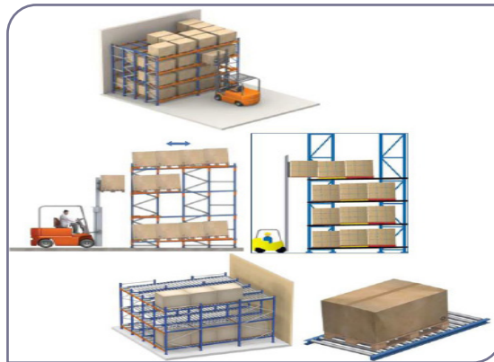
شکل ۴-۸. سیستم قفسه پالتی از نوع Push Back
