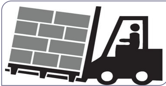
شکل ۱۷-۵. چگونگی قرارگیری شاخک لیفتراک زیر پالت
