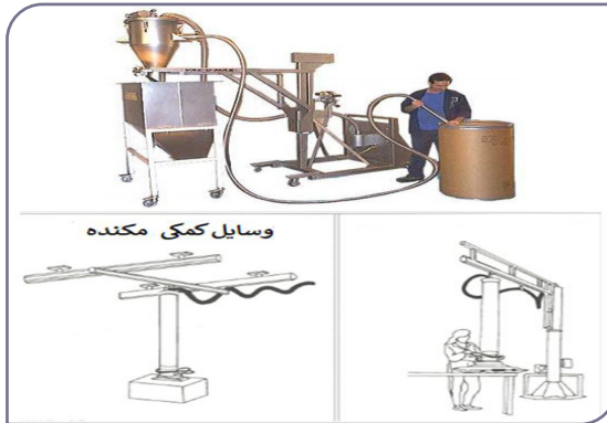
شکل ۵-۶. استفاده از سیستم مکندۀ برای جابجایی مواد و حمل مواد
