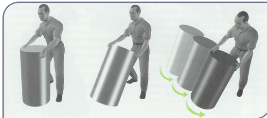
شکل ۱۸-۶. روش بلندکردن بار برای بارهای بشکه‌ای
