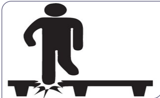
شکل ۱۵-۵. فشار نقطه‌ای روی پالت
