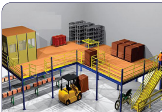
شکل ۲۲-۵. ایجاد نیم طبقه در انبار
