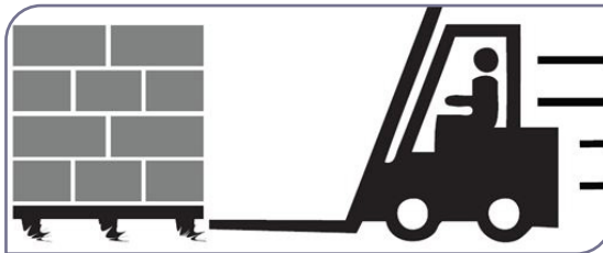
شکل ۱۸-۵. عدم هل دادن پالت با استفاده از شاخک لیفتراک
