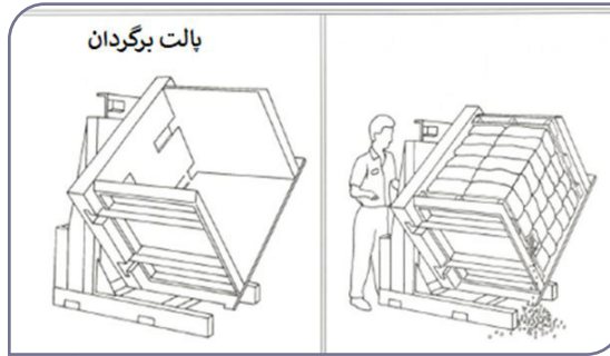
شکل ۸-۶. استفاده از وسایل مکانیکی - پالت گردان
