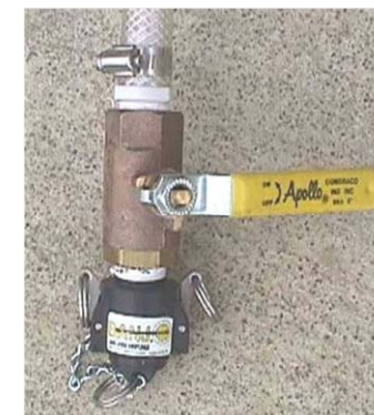
شکل ۸- شیلنگ و شیر توپی برای انتقال آفت کش به سم پاش کوله پشتی
