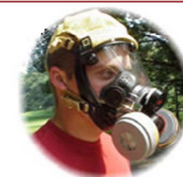
شکل ۳۵- نمونه ای از یک رسپراتور تمام صورت تصفیه کننده هوا
