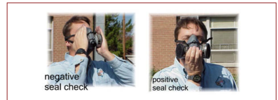
شکل ۴۵- مراحل انجام تست کپ بودن رسپیراتور
