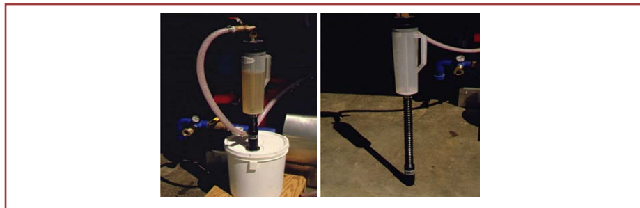
شکل ۶- استفاده از دستگاه انتقال محصور برای آفت کش های مایع
